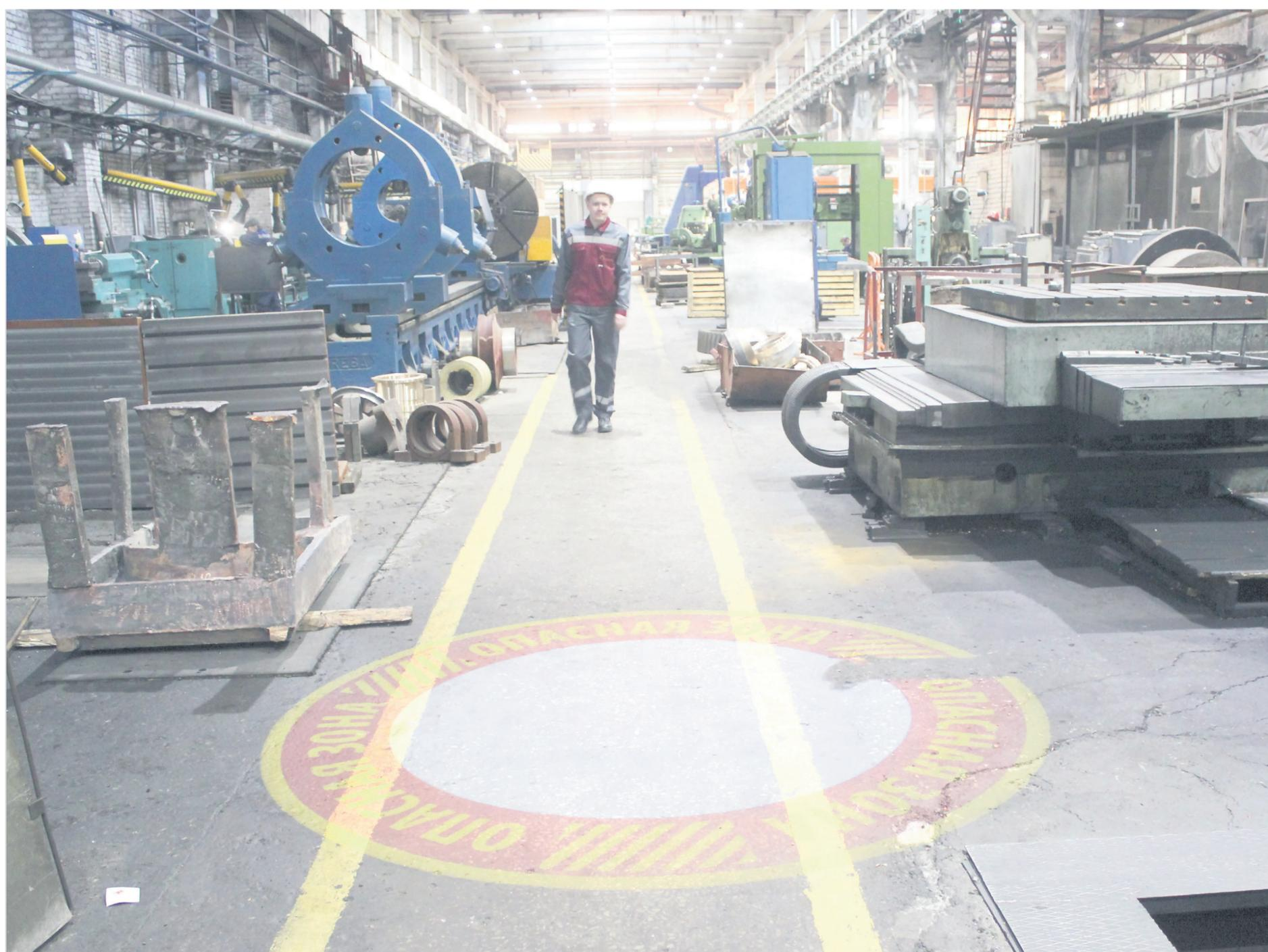
Гобо-проектор подсвечивает зону под крюком крана и вместе с грузом передвигается по территории цеха. Знак заметный – яркий рисунок хорошо виден на любой поверхности и при любом освещении. // Фото Екатерины Городко
