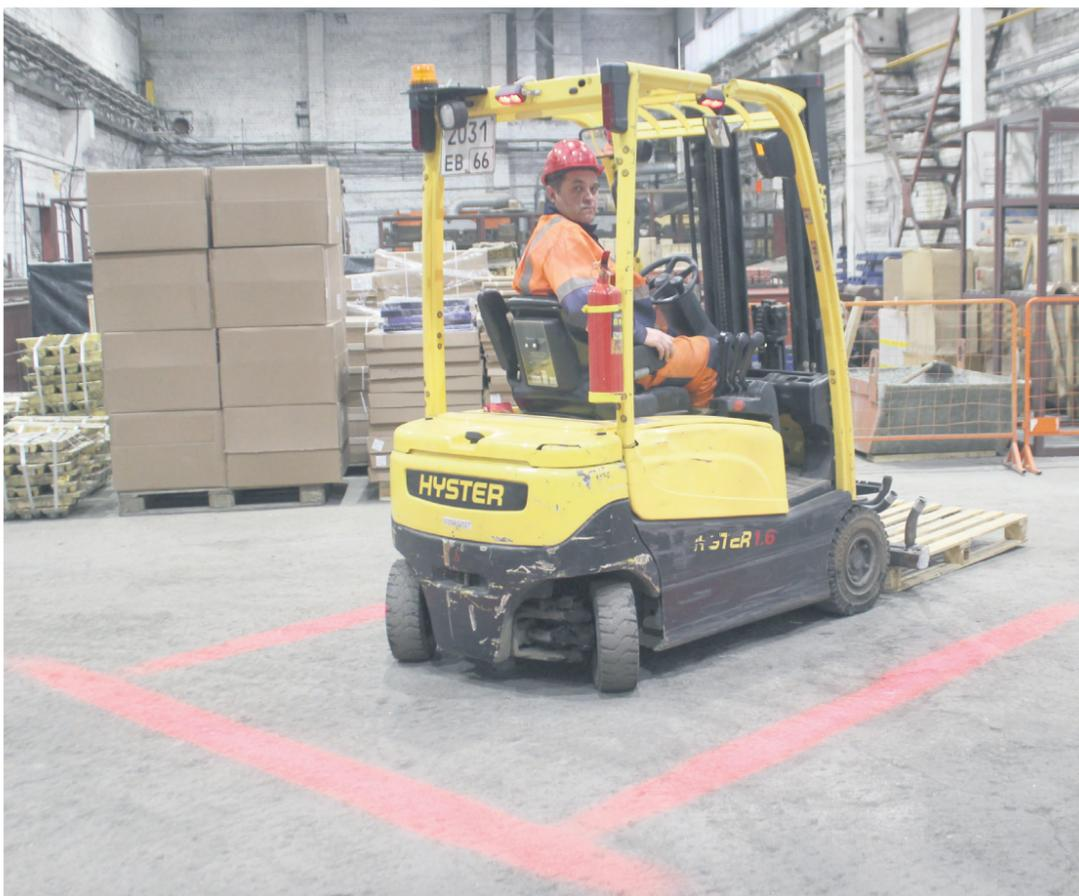
В РМЦ один из погрузчиков оснастили фонарями световой визуализации. Они проецируют вокруг техники красные линии, которые формируют световое ограждение, обозначающее зону повышенной опасности. Анатолий Белоглазов, водитель электрического погрузчика, отметил, что это отличное нововведение, работники видят его и зону, к которой лучше не приближаться. // Фото Екатерины Городко
