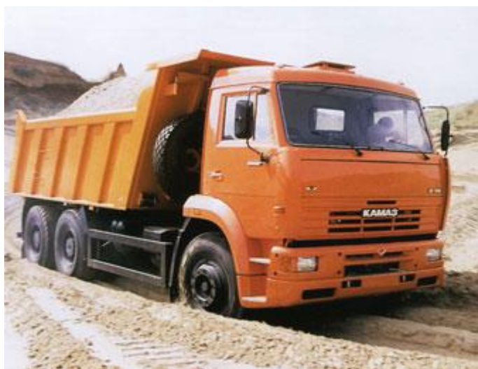
Рисунок 7.5 – Автосамосвал КамАЗ-6520-06 грузоподъемностью 20,0 тонн
