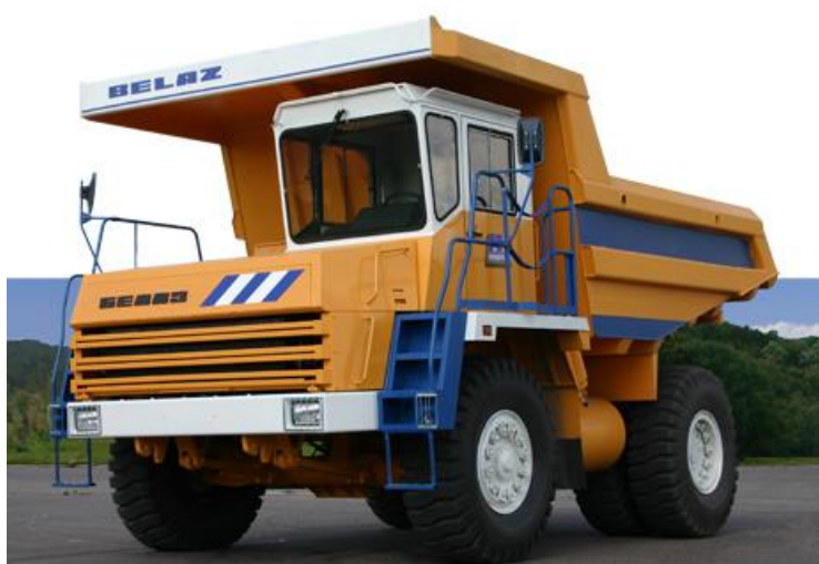
Рисунок 7.6 – Автосамосвал БелАЗ-75405 грузоподъемностью 30,0 тонн
