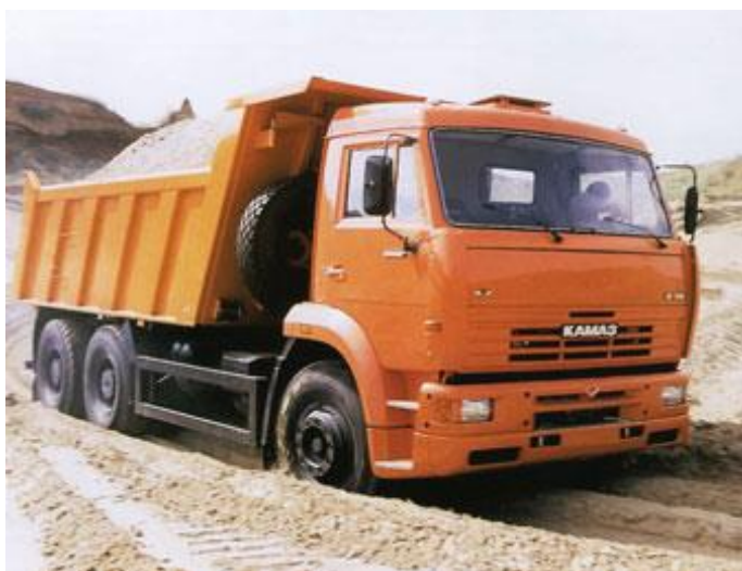
Рисунок 6.4 – Автосамосвал КамАЗ-6520-06 грузоподъемностью 20,0 тонн
