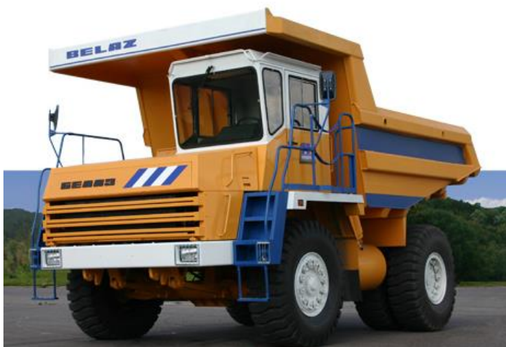
Рисунок 6.5 – Автосамосвал БелАЗ-75405 грузоподъемностью 30,0 тонн
