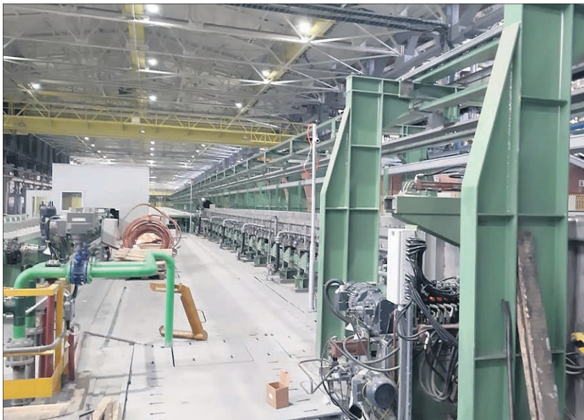
Выходная система для прессованных продуктов в отрезках и бухтах пресса 35МН
