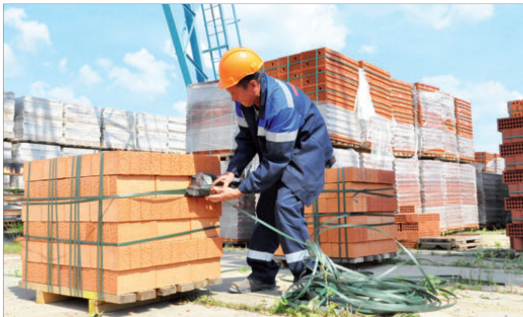
Салават Нурисламов обвязывает поддон с кирпичом полиэтиленовой пленкой ПЭТ с помощью специальной электрической машинки.
