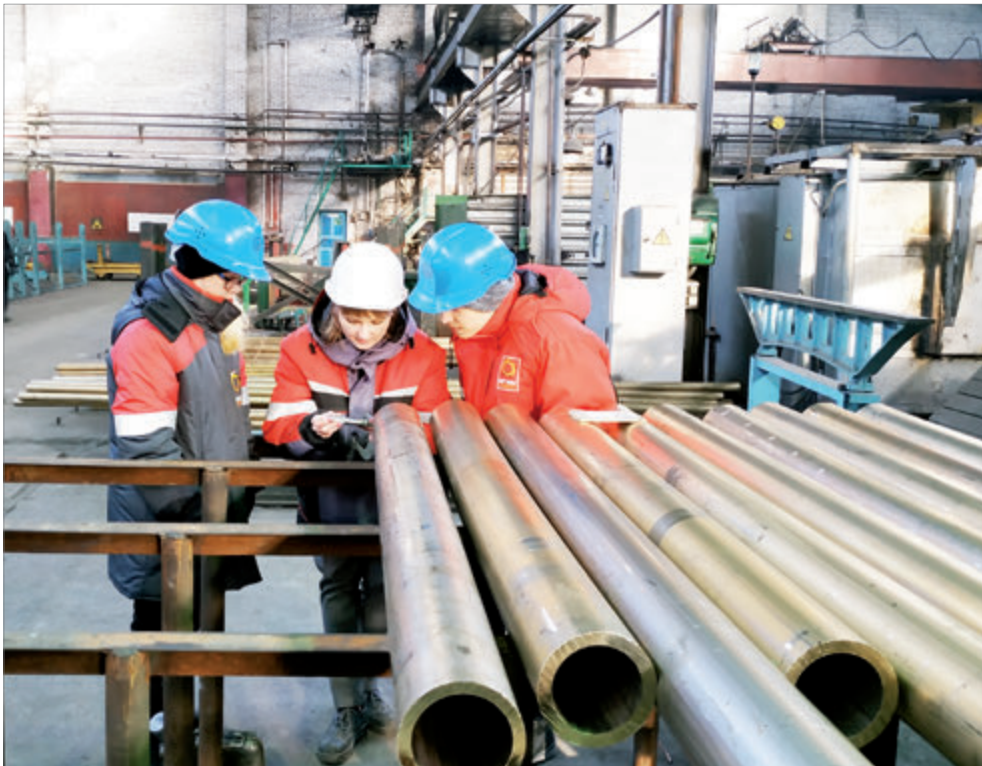
Начальный этап работы «Сбор данных». С помощью наставника Анны Герасимовой, Ксения и Никита снимали геометрические размеры труб.
